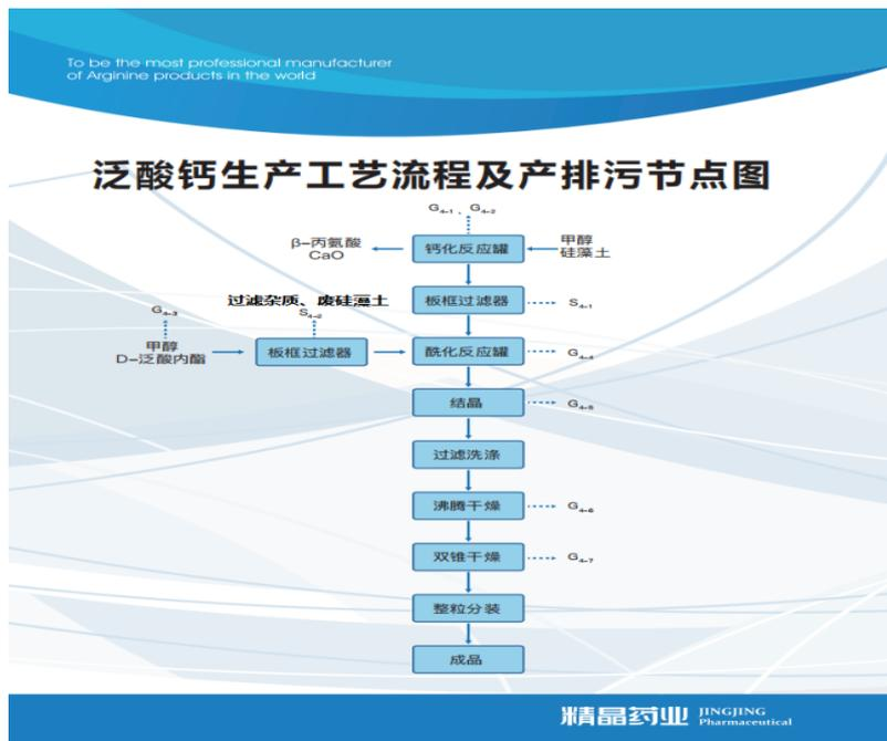
年产 1000 吨无菌原料药项目主要生产工艺及污染物产出流程：本项目生产主要通过原料溶解、过滤、重结晶的过程，来达到除菌、提纯的目的。
